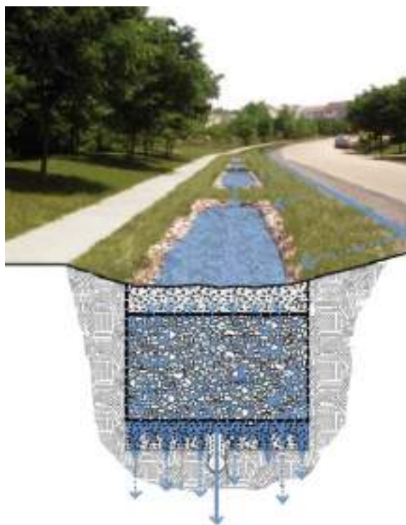
Fig.4.6: Esempio di trincea d'infiltrazione
