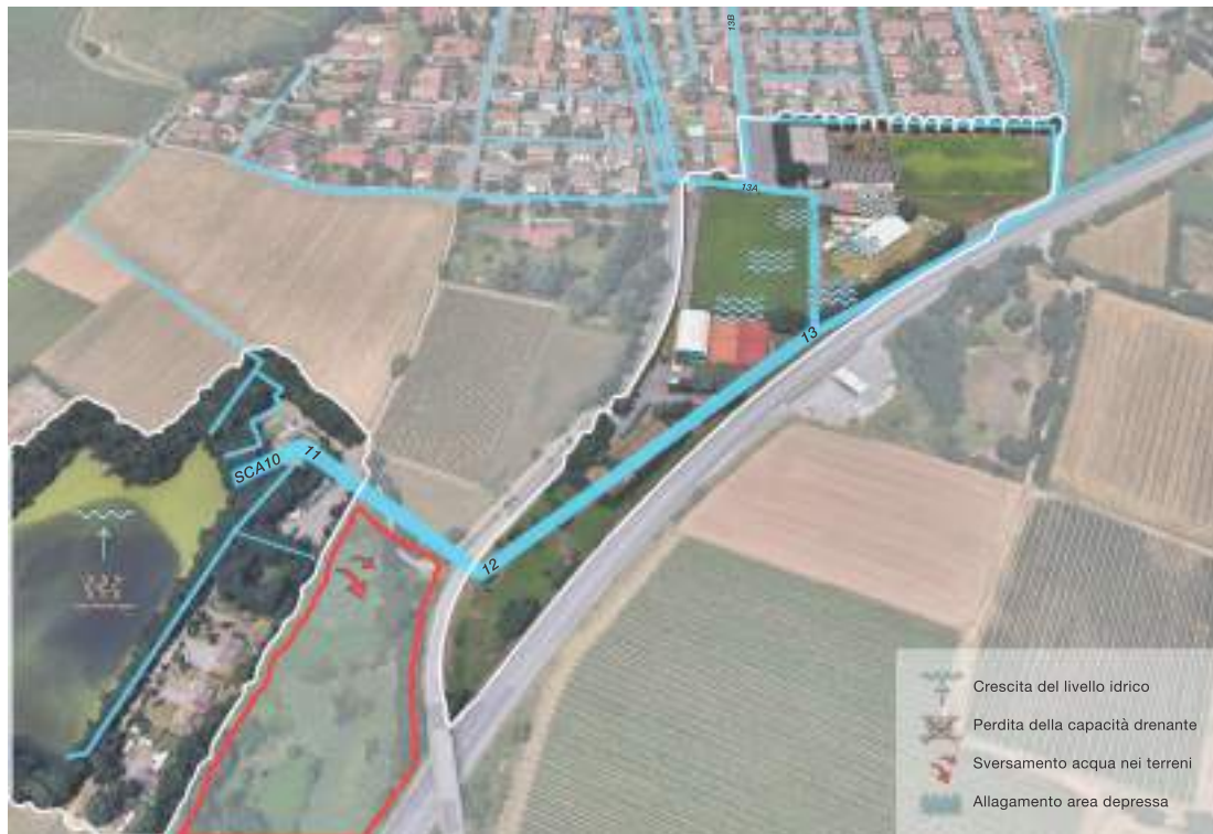
Fig.4.32: Fenomeno del rigurgito idraulico con conseguente allagamento del centro sportivo
