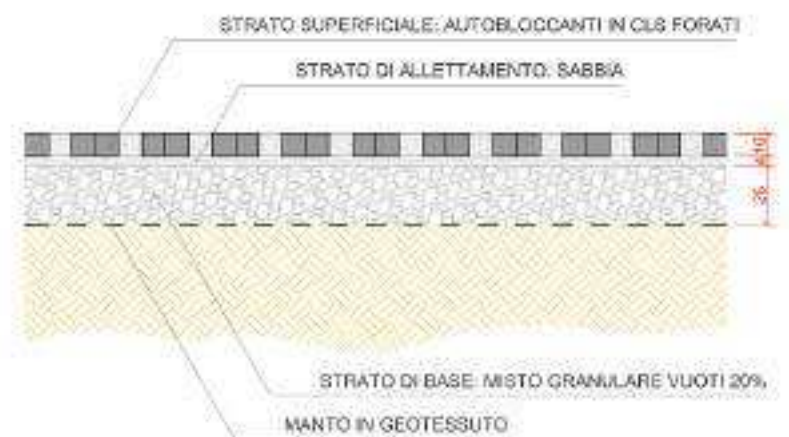
Fig.4.44: Stratigrafia superficie permeabile
