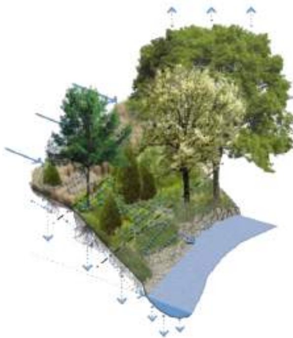
Fig.4.5: Esempio di fascia filtro-tampone
