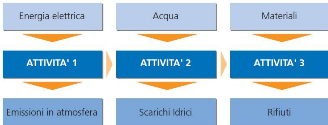
Figura 2.2 - Modello di riferimento per la valutazione ambientale di un processo.
