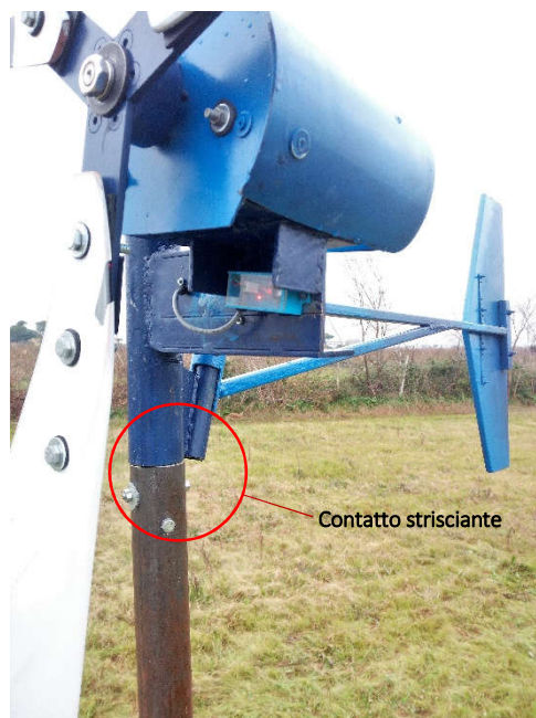
Fig.6.20: Particolare del punto di congiunzione fra navicella e il palo di supporto
