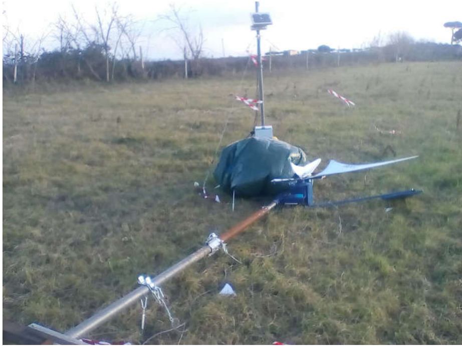
Fig.6.5: Foto scattata sul campo volo il giorno dopo il cedimento dei tendicavi
