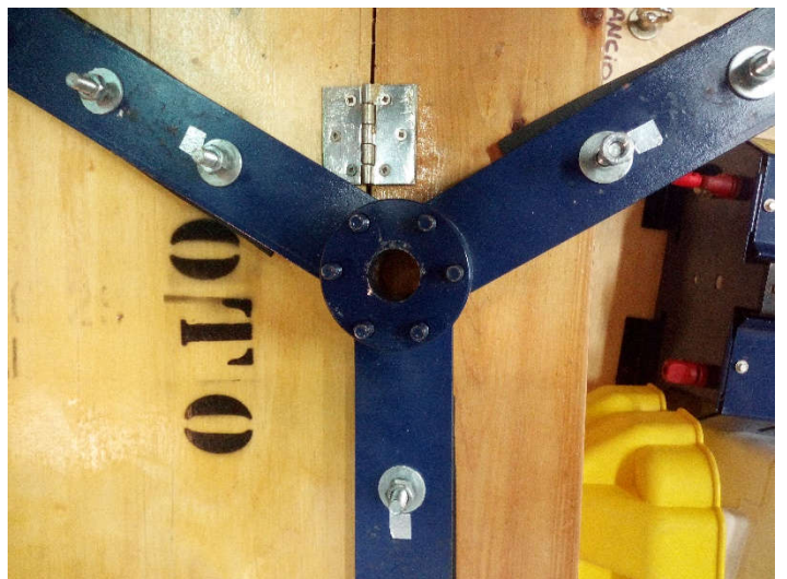
Fig. 5.15: Rotore con superfici riflettenti
