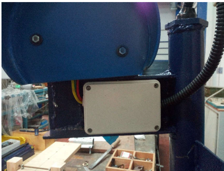
Fig.5.9: Alloggiamento ponte trifase
