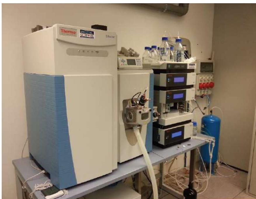
**Figura 3.13:** il cromatografo liquido ad alte pressioni accoppiato allo spettrometro di massa usato per le analisi riguardanti i farmaci (tratto da Ecoresarch et al., 2016)
