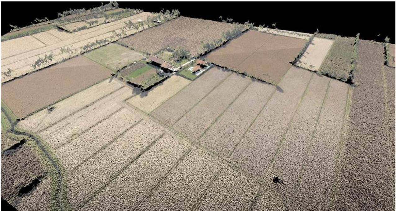
Fig.27 - Nuvola di punti 3D estratta dal rilievo aereo. Fonte: UniSky.
