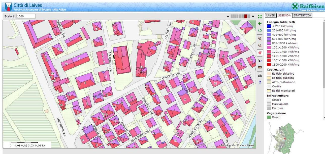
Fig.21 - EcoGIS Laives. Interfaccia interoperabile sul potenziale energetico delle falde edilizie.
