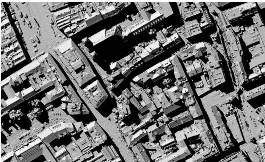
Fig.28 - DSM estratto dalla nuvola di punti "Dense Image Matching". Fonte: UniSky.
