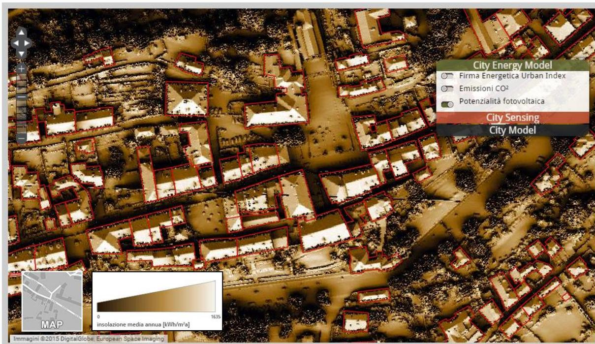
Fig.10 - Rappresentazione all'interno dell'Urban Energy Web del potenziale fotovoltaico derivante dalle coperture edilizie. Fonte: Urban Energy Web Feltre.
