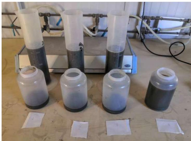
**Figura 4.3:** Separazione della fase liquida, nel cilindro graduato, e dalla fase solida, nel barattolo, del refluo suino a seguito della centrifuga.
