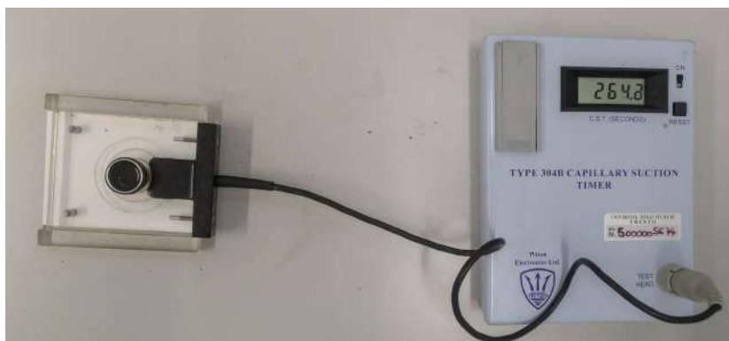
**Figura 4.12:** Timer di suzione capillare tipo 304B fabbricato da Triton Electronics Ltd.
