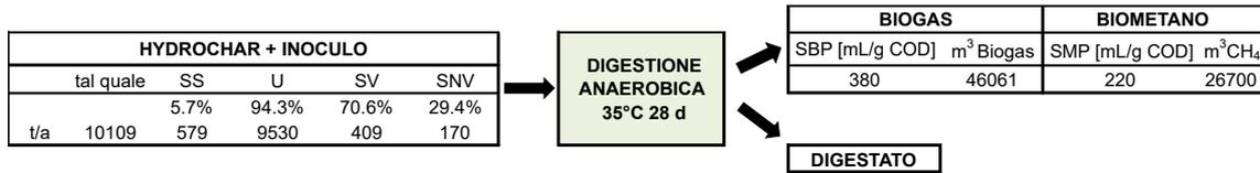
Figura 5.31: Bilancio di massa della digestione anaerobica dello scenario 2.
