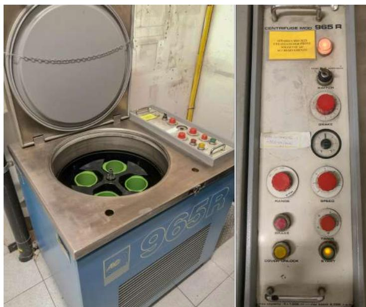
**Figura 4.2:** Centrifuga MOD 965 R utilizzata per addensare il refluo suino.
