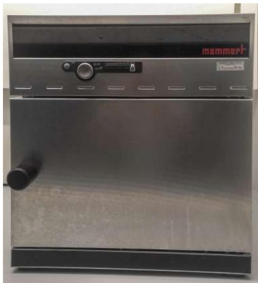
**Figura 4.10:** Forno utilizzato per l'essiccazione a 105°.
