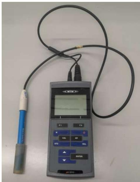
**Figura 4.14:** pHmetro *WTW modello pH3310* utilizzato per effettuare la misura del pH
