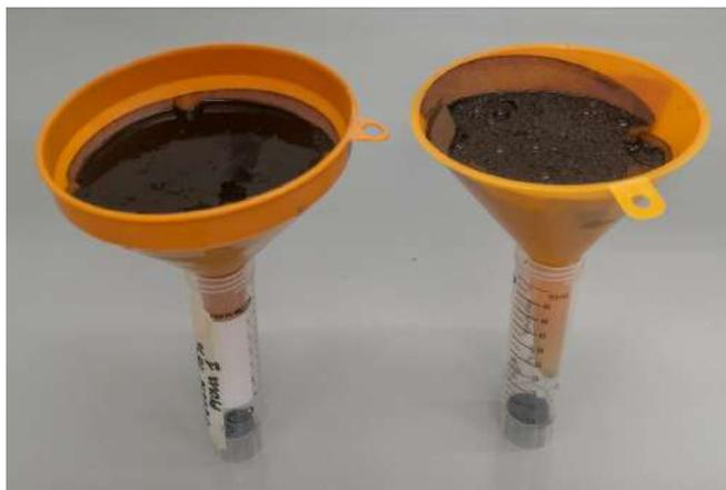
**Figura 4.8:** Separazione solido-liquido dell'HTC slurry.
