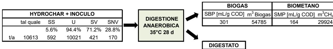
Figura 5.36: Bilancio di massa della digestione anaerobica dello scenario 3.
