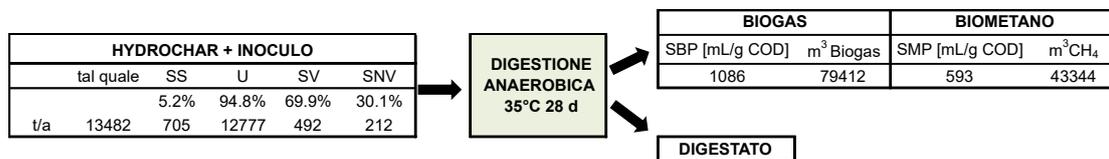
Figura 5.26: Bilancio di massa della digestione anaerobica dello scenario 1.
