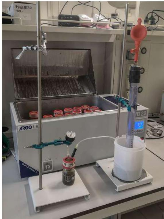
**Figura 4.9:** Strumentazione per il test BMP
