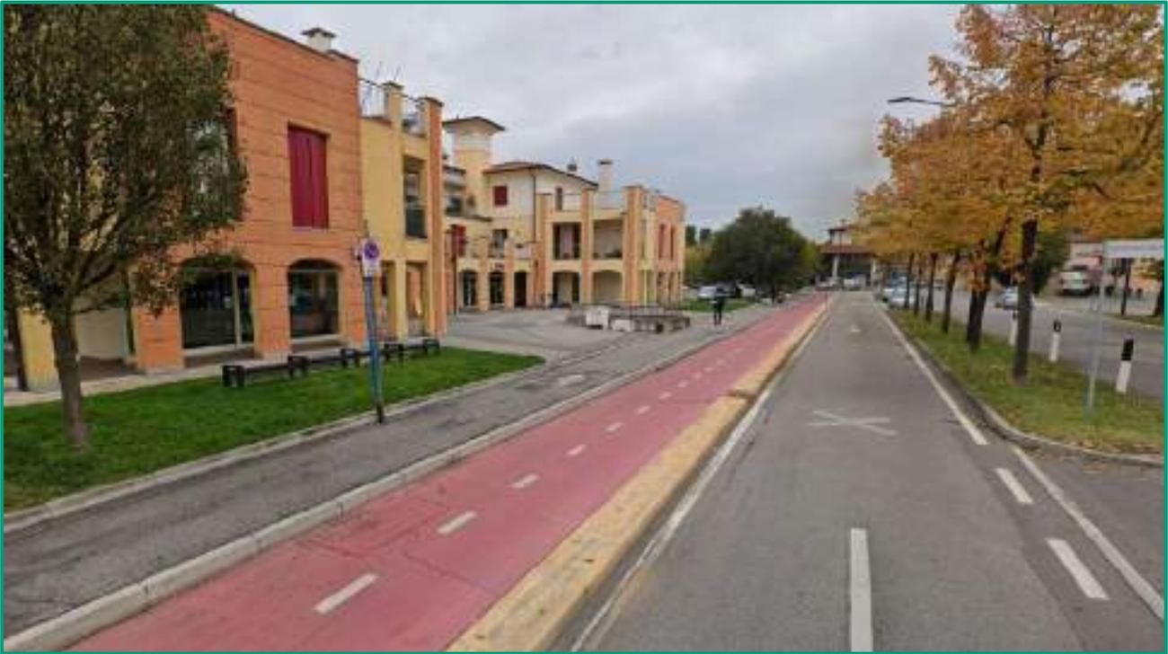
Fig. 19: Esempio di pista ciclabile in sede propria (caso 1); il senso è doppio e la pista è separata dalla carreggiata tramite un cordolo (Comune di Chiari, fonte immagine: [www.google.it/maps](http://www.google.it/maps)).
