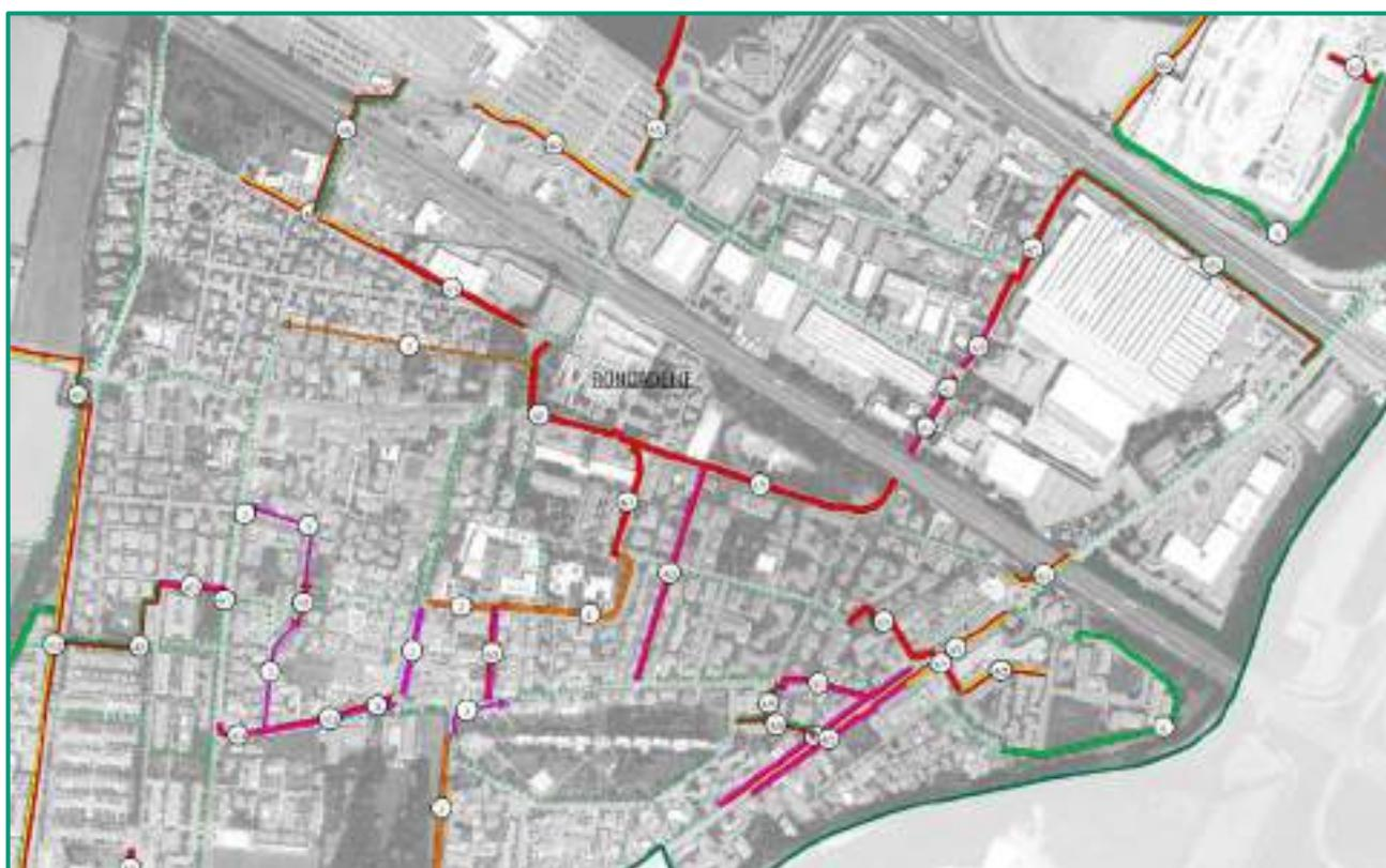
Fig. 30: Esempio di una sezione della tavola che mostra la classificazione dei percorsi ciclo-pedonali secondo la loro tipologia, nel comune di Roncadelle.
